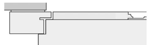
**Aufgetrennte Türen lassen sich mit einer speziellen Mittelschicht ertüchtigen.**
