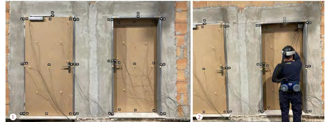
Images 1 & 2 : test de résistance au feu au centre d'essai
