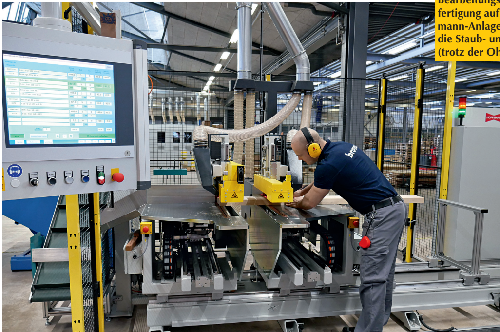
Querholzsäge von Hoffmann als CNC-BAZ-Alternative für die Türenfabrik Brunegg AG
