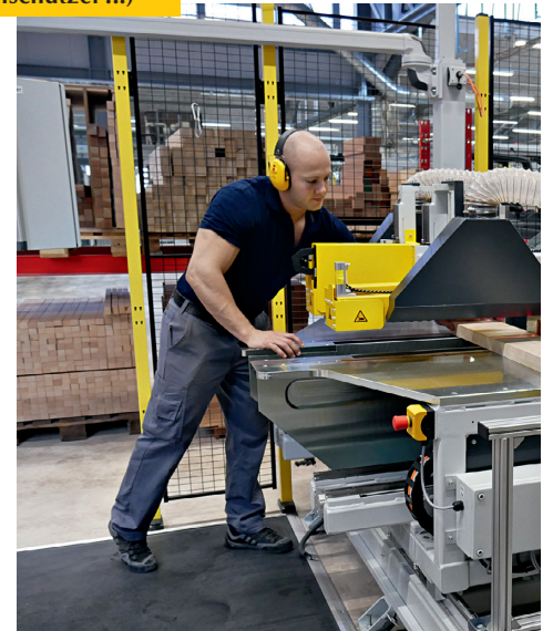
Querholzsäge von Hoffmann als CNC-BAZ-Alternative für die Türenfabrik Brunegg AG
