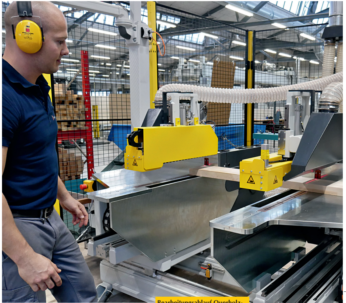
Bearbeitungsablauf Querholzfertigung auf der neuen Hoffmann-Anlage; zu beachten ist die Staub- und Lärmfreiheit (trotz der Ohrenschützer ...)
